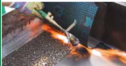
1. Application de DEFEND ANTIRADICE dans le dispositif d'essai
