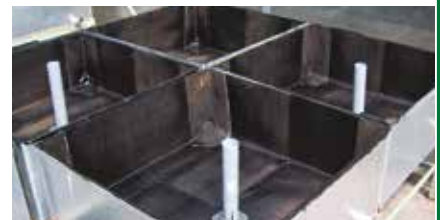
2. Bassins d'essai imperméabilisés
