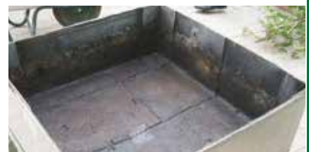
8. Face supérieure de DEFEND ANTIRADICE après le test
