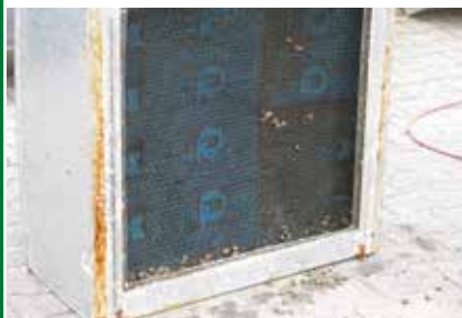
9. Face inférieure de DEFEND ANTIRADICE inaltérée après le test
